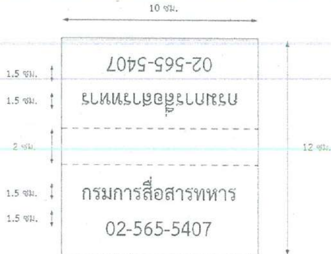
รูปที่ ๒ สติกเกอร์สีดำ ชนิดป้องกันรังสี UV ขนาด ๑๐x๑๒ ซม. พร้อมตัวอักษร
